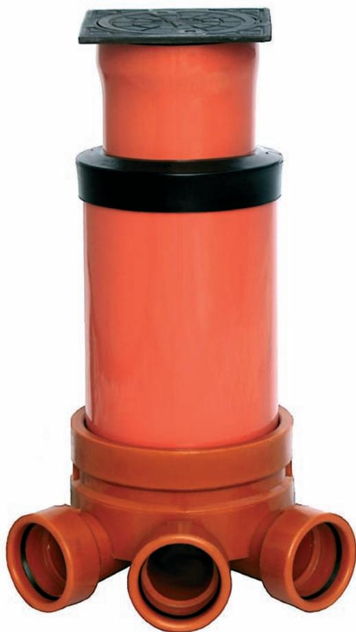
**Ревизионные колодцы** — это канализационные колодцы с наружным диаметром шахтной трубы соответственно 315 мм и 400 мм, диаметры подсоединяемых канализационных труб из ПВХ, ПП или ПЭ от 110 мм до 400 мм. Такие колодцы предназначены для выполнения эксплуатационных работ в канале с поверхности земли, а именно: осмотра, чистки, промывки, определения наличия деформаций.
