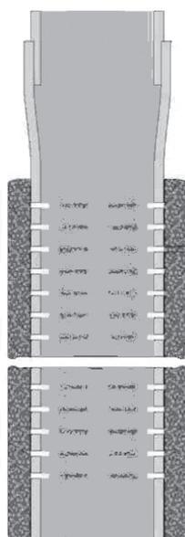
На базе ООО «Металлпласт» освоено производство скважинных фильтров с покрытием из пеноистого полипропилена (ПП). Защитно-фильтрующее покрытие такого фильтра предотвращает попадание твердых частей породы из водоносного слоя в скважинную колонну.
