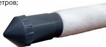
Для удобства монтажа и с целью недопущения попадания твердых частей породы в ствол обсадной колонны через нижнее входное отверстие, производится и поставляется конусная заглушка, которая с легкостью накручивается на резьбу скважинного фильтра.
